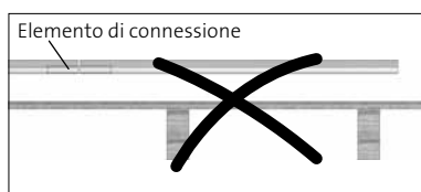
Fig. B 5-3, dettaglio 1 Profilo non possibile senza collegamento diretto!
