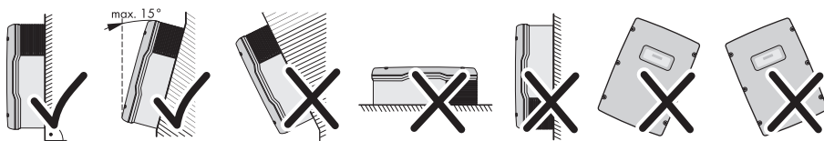
Figura 11: Posizioni di montaggio consentite e non consentite
